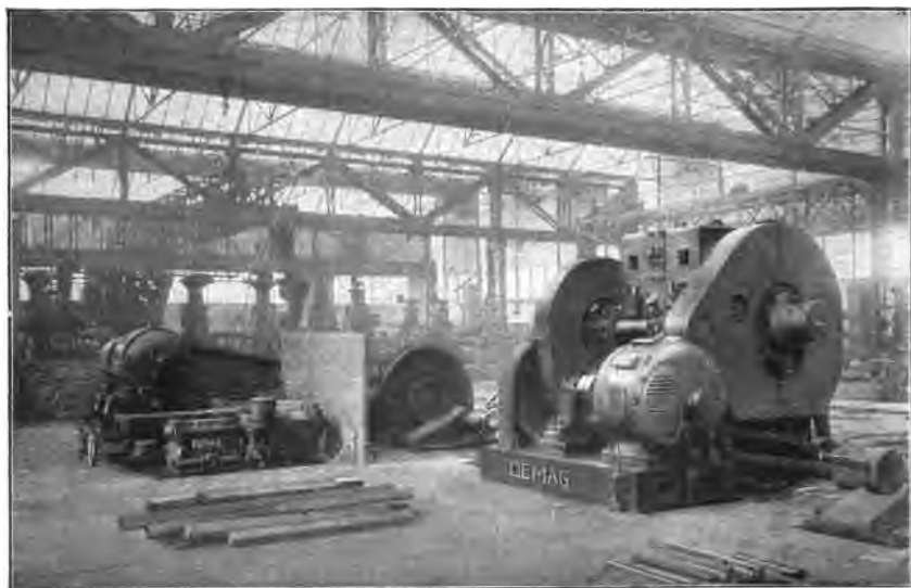
1. Sierra de carro con avance automatico de corriente continua, 1500 mm. diametro hoja sierra. 2. Cizalla, 160 por 160 mm. con motor trifásico.
