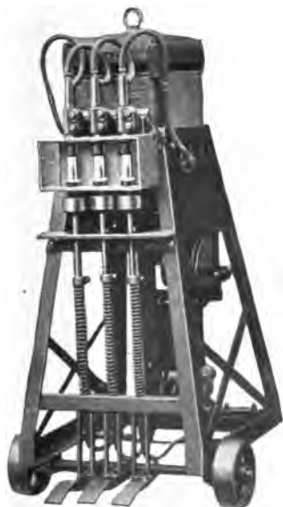
Calentador eléctrico de roblones, para calentar tres á un mismo tiempo.
