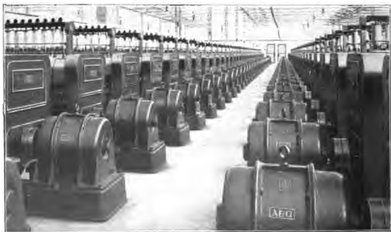
Fig. 4. Continuas de anillos para hilar. Accionamiento directo por motor cerrado trifásico de polos reversibles, 950 y 720 r. p. m. Para la admisión de escape del aire de refrigeración existe una canal debajo de los motores.
