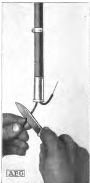
Fig. 30. Buen corte de la capa aisladora. El cuchillo casi paralelo al alambre.
