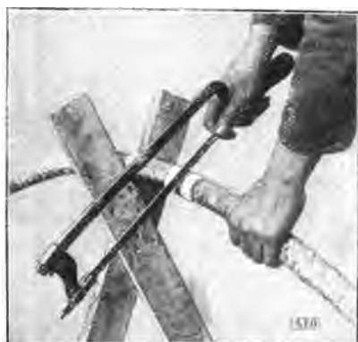
Fig. 87. Cortando el cable procurar no doblarlo demasiado los dos lados del corte se atan previamente.
