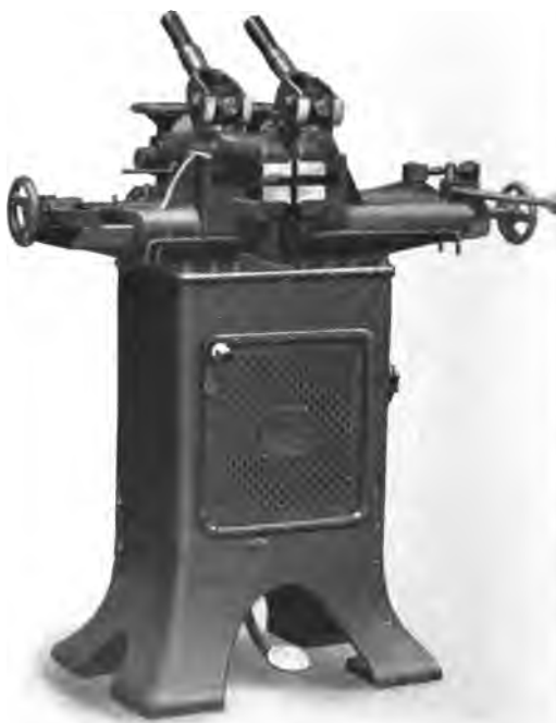
Máquina para soldar á tope para la pequeña industria, capacidad 7.5 kilovatios.
