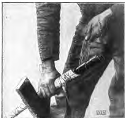
Fig. 88. Separando la parte exterior de yute.
