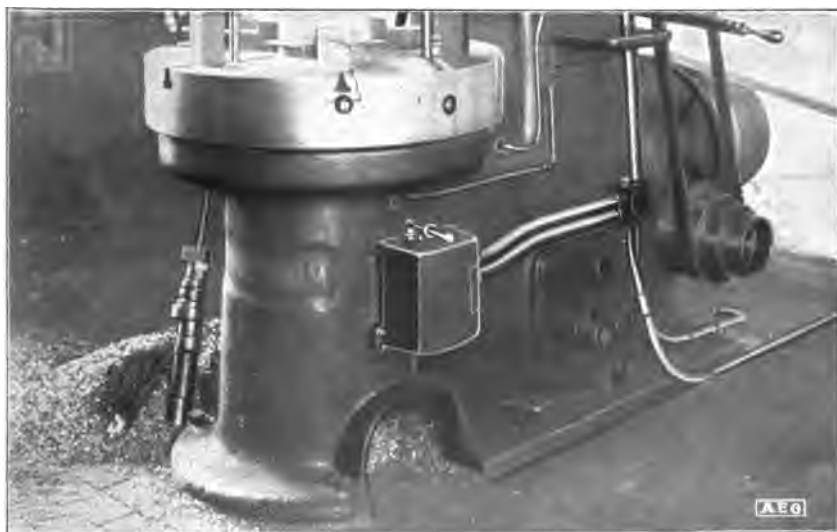
Fig. 61. Instalación de tubo protector de acero en una máquina.
