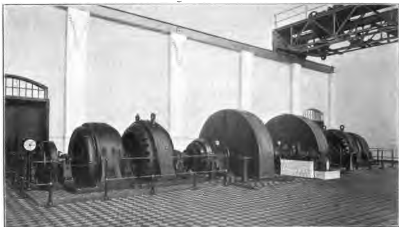
Fig. 2. Convertidor sistema Leonard para accionamiento de la máquina de extracción.
