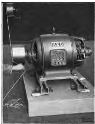
Fig. 16. El árbol motor no está aún paralelo al árbol de transmisión.
