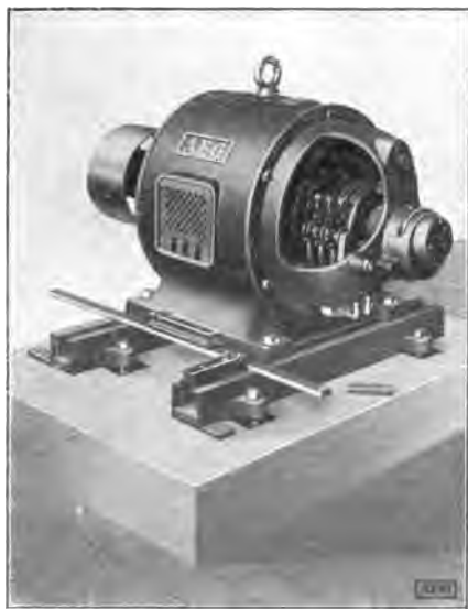
Fig. 14. Nivelando con un nivel de agua antes de sujetar con cemento los carriles. El motor está atornillado á los carriles.
