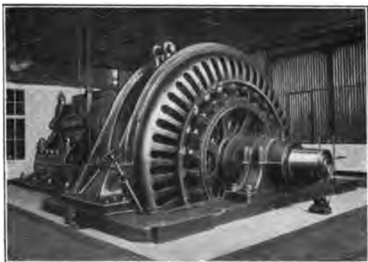
Fig. 2 Motor reversible corriente continua para 160 m. t. correspondiente á 10 300 H. P. y 46 r. p. m. para accionamiento de los aparatos de corte de metales (cizallas, sierras, etc.).
