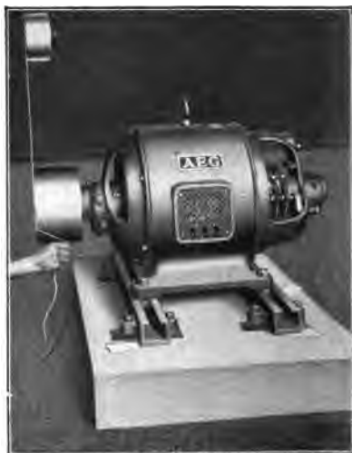
Fig. 17. El árbol motor está paralelo al árbol de transmisión.
