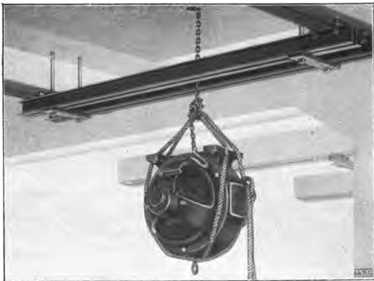
Fig. 9. Montaje de un motor en el techo.
