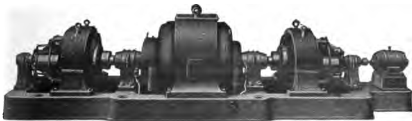
Motor-generador, compuesto de un motor trifásico, 1500 r. p. m, 2000 kW, dos dinamos corriente continua y una excitatriz.
