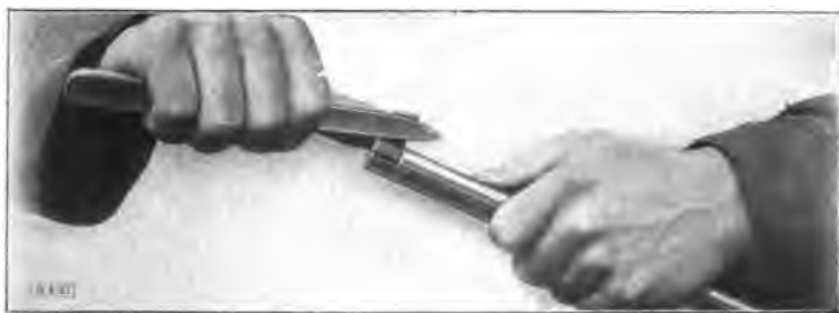
Fig. 1. Quitando la cubierta de la extremidad del tubo.
