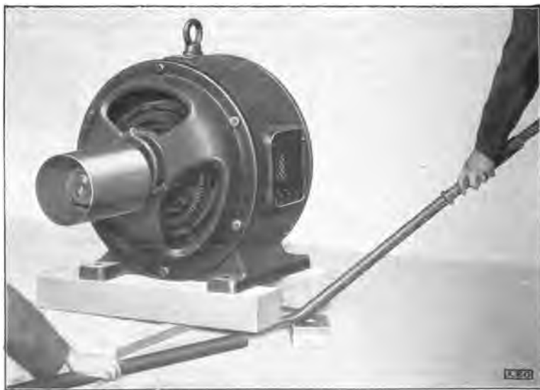
Fig. 1. Levantando el motor para meter el primer rodillo.
