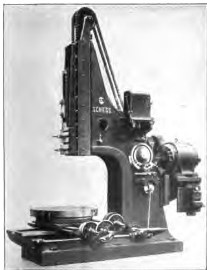
Fig. 5. Máquina de mortajar con motor reversible y regulable.
