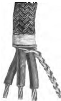
Fig. 120. Cable flexible prepa- rado para unir á los enchufes.
